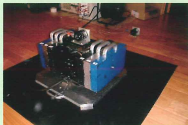
①振動機で強制加振 (体感は震度1程度)
